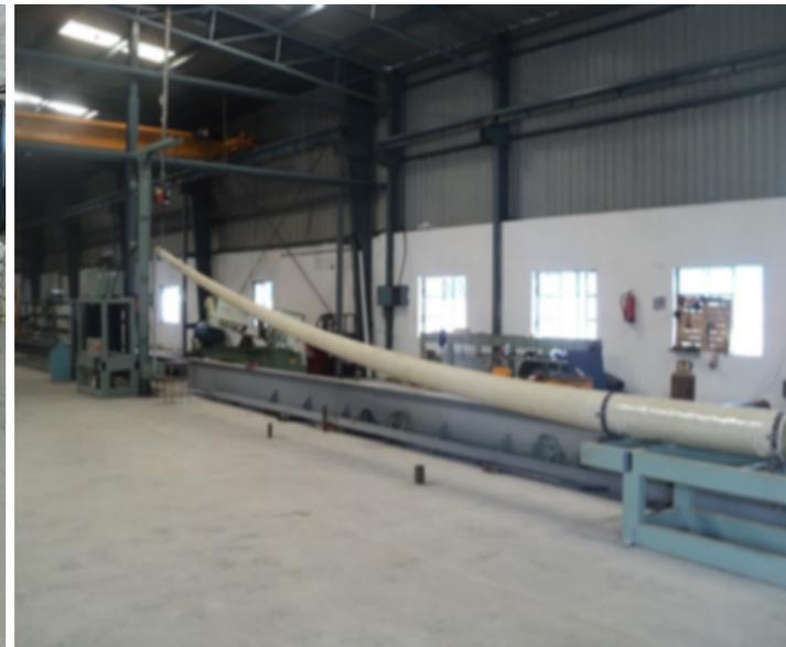
ОПОРЫ ОСВЕЩЕНИЯ, А ТАКЖЕ ОПОРЫ ЛЭП, ИЗГОТОВЛЕННЫЕ ИЗ КОМПОЗИЦИОННОГО МАТЕРИАЛА – ДОСТОЙНАЯ АЛЬТЕРНАТИВА РАНЕЕ ПРИМЕНЯЕМЫМ ТРАДИЦИОННЫМ МАТЕРИАЛАМ, ТАКИМ КАК ДЕРЕВО, СТАЛЬ, АЛЮМИНИЙ И ЖЕЛЕЗОБЕТОН, МНОГОКРАТНО ПРЕВОСХОДЯЩАЯ ИХ ПО СВОИМ ЭКСПЛУАТАЦИОННЫМ ПАРАМЕТРАМ
