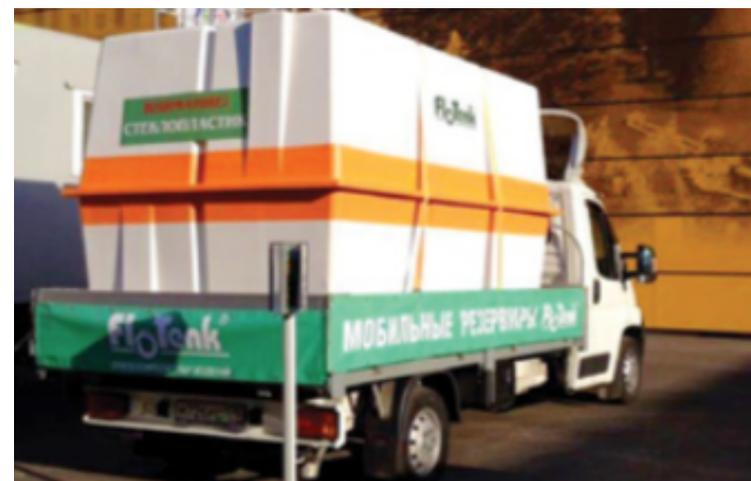
СТЕКЛОПЛАСТИКОВЫЕ АВТОЦИСТЕРНЫ ПРЕДНАЗНАЧЕНЫ ДЛЯ ТРАНСПОРТИРОВКИ И ВРЕМЕННОГО ХРАНЕНИЯ ЛЮБЫХ ВИДОВ ЖИДКОСТЕЙ (В ТОМ ЧИСЛЕ ХИМИЧЕСКИ АГРЕССИВНЫХ СРЕД (КИСЛОТ, ЩЕЛОЧЕЙ, НЕФТЕПРОДУКТОВ И Т.Д.).
