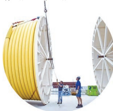
РИС. 6. Термопластичные композитные трубы для шельфовой добычи
